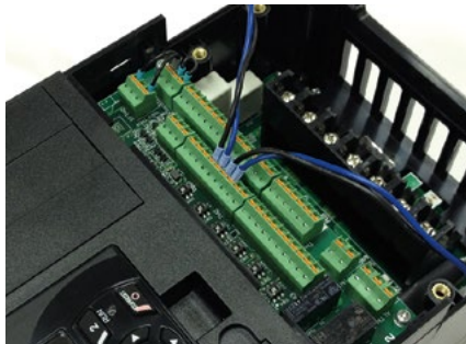
Modbus-Kommunikation mit doppelten Anschlussklemmen zur einfachen Realisierung von Daisy-Chain-Verdrahtungen.
