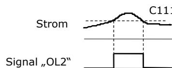
Einstellen der Reaktionszeit für diese Funktion erfolgt mit den Funktionen C901 und C902. Die Schalthysterese wird unter Funktion C903 eingestellt.
